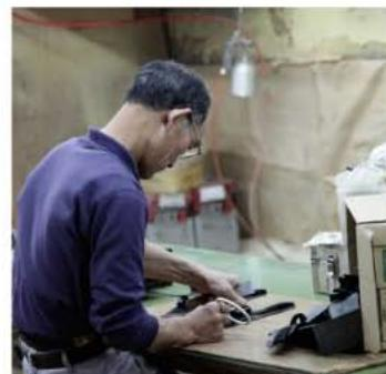
取付ける革パーツの下処理作業。縫製時にズレが生じないように両面テープをつけています。
