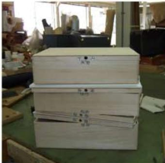
木工部門で作られたアタッシュケースに使われる木枠。これから革と縫い合わされ、金具を取付けて内装の仕上げに進みます。
