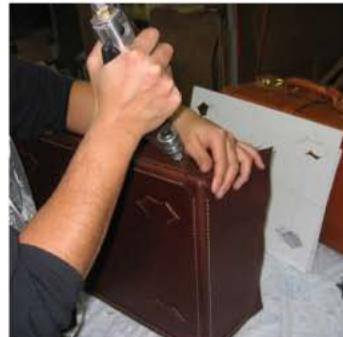
手縫い部分に糸を通す穴をあけているところ。後ろに見える白い紙は、パーツの取付け位置を合わせるための型紙。
